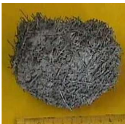
Figura 2.3 – Aglomerados de fibras de aço. Fonte: Figueiredo (2011).
